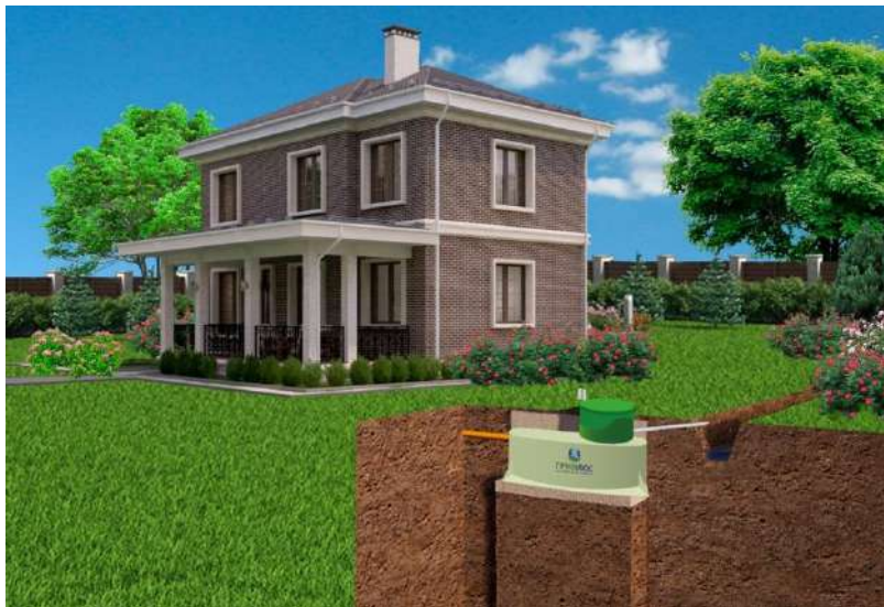
Рисунок 17. Монтаж с принудительным забором воды в фильтрующий колодец (Модели со стандартной высотой корпуса)
