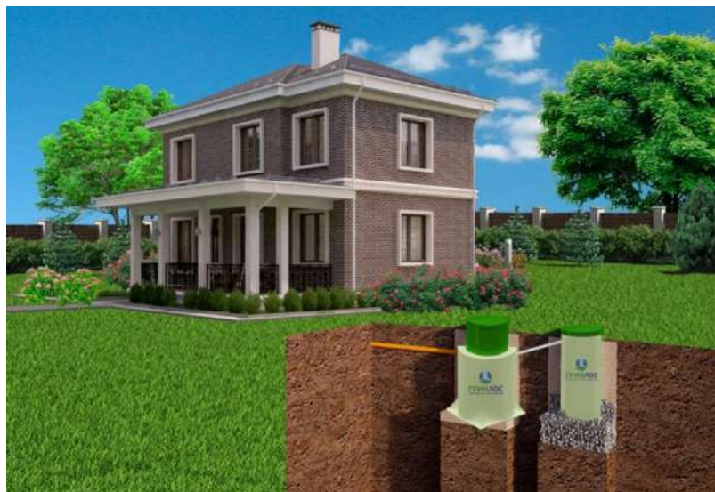
Рисунок 17. Монтаж с принудительным забором воды в фильтрующий колодец (Модели со стандартной высотой корпуса)
