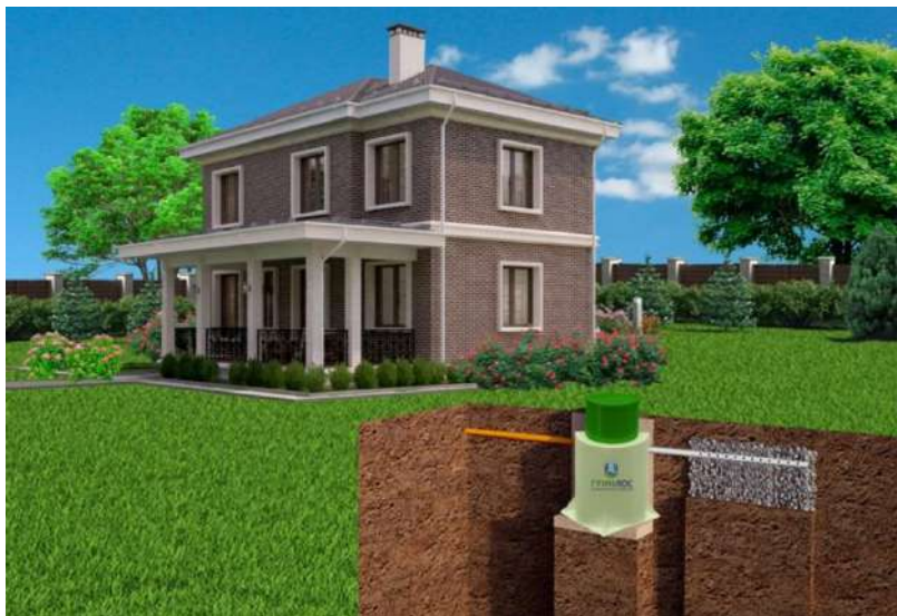
Рисунок 14. Монтаж с отводом очищенных сточных вод в фильтрующий колодец
